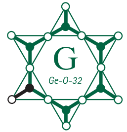
Netzstruktur des Germanium
